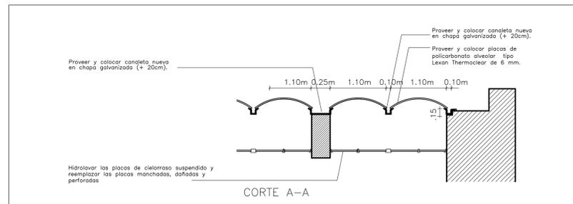
CORTE TRANSVERSAL DE LA CUBIERTA
